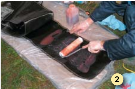
Bild 5: Mit einer Walze wird die Karbonmatte angeedrückt.
